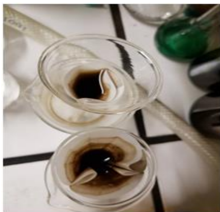
Сурет 5 – Ұнтақталған белсендірілген көмірі бар (0,4 г/л) \text{CrCl}_3 су модельдік ерітінділерінің жиынтығы (50-1000 м. ү.)
