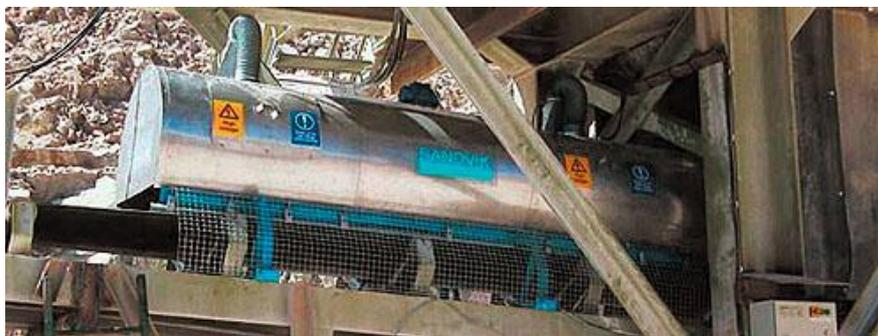
Рисунок 1. Установка для удаления минеральных частиц из окружающего воздуха в точках перегрузки продукции на ленточный конвейер
