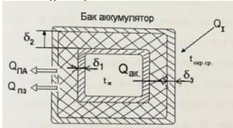
1-сурет. Батарея ыдысының жобалық схемасы
