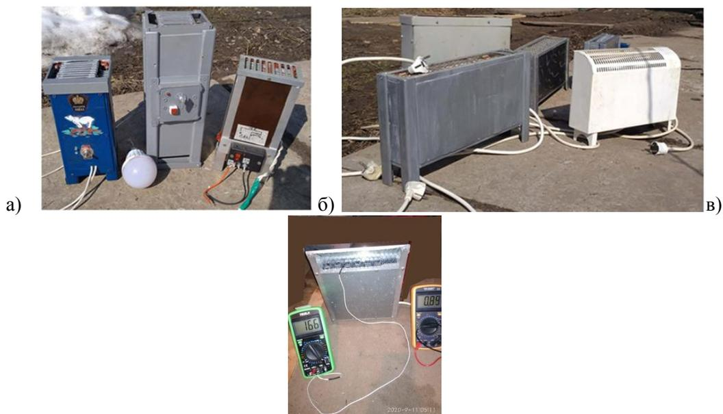
Рисунок 8 Воздушные конвекторы на позисторах а) мощностью 100 Вт, 300 Вт и 500 Вт на напряжении 12, 24, 48 В; б) мощностью 1,0 кВт, 1,5 кВт на напряжении 220 В; в) Для бытовых нужд и ж/д транспорта  $T=166^{\circ}\text{C}$ , мощность потребления 196 Вт
