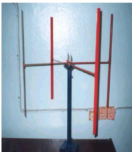
Сурет 9. Бидарье жел турбинаның лабораториялық моделі
