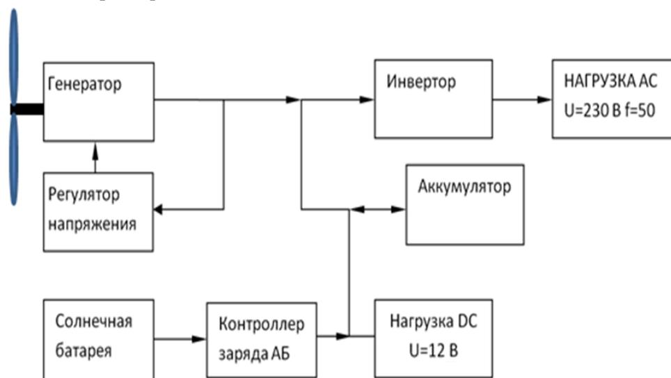
Рисунок 3 Структурная схема зарядной станции с ветро-солнечными первичными источниками энергии
