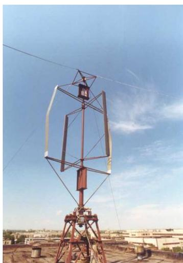
Сурет 10. Қалақшалары қарама қарсы бағытта айналатын Бидарье (7 кВт) турбинаны
