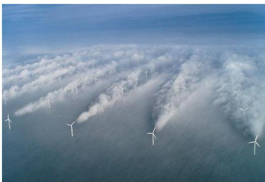
Сурет 4. Пропеллерлік жел турбинасының артындағы құйын
